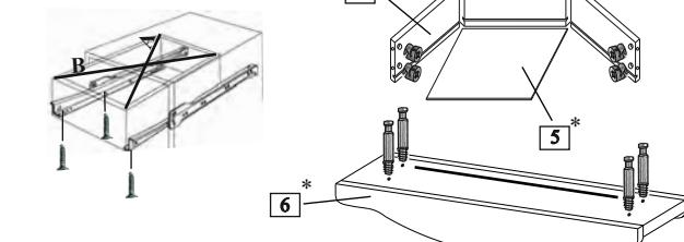
В накладку ящика вворачивается дюбель эксцентриковой стяжки. Ящик складывается согласно схеме, в паз вставляется дно, накладка стягивается с корпусом ящика. **Предварительно просверлив отверстия Ø 2,5 мм**, крепятся направляющие шурупами 4x13. Шурупом 4x16 через фиксатор приворачиваем дно ящика (рис. №6)
